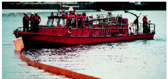
Das Löschboot der FW Spandau-Süd zieht die Ölsperre über die Havel.
