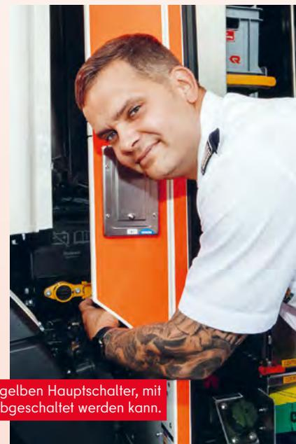
Bastian Proft zeigt den gelben Hauptschalter, mit dem der Hochvoltstromkreislauf abgeschaltet werden kann.
