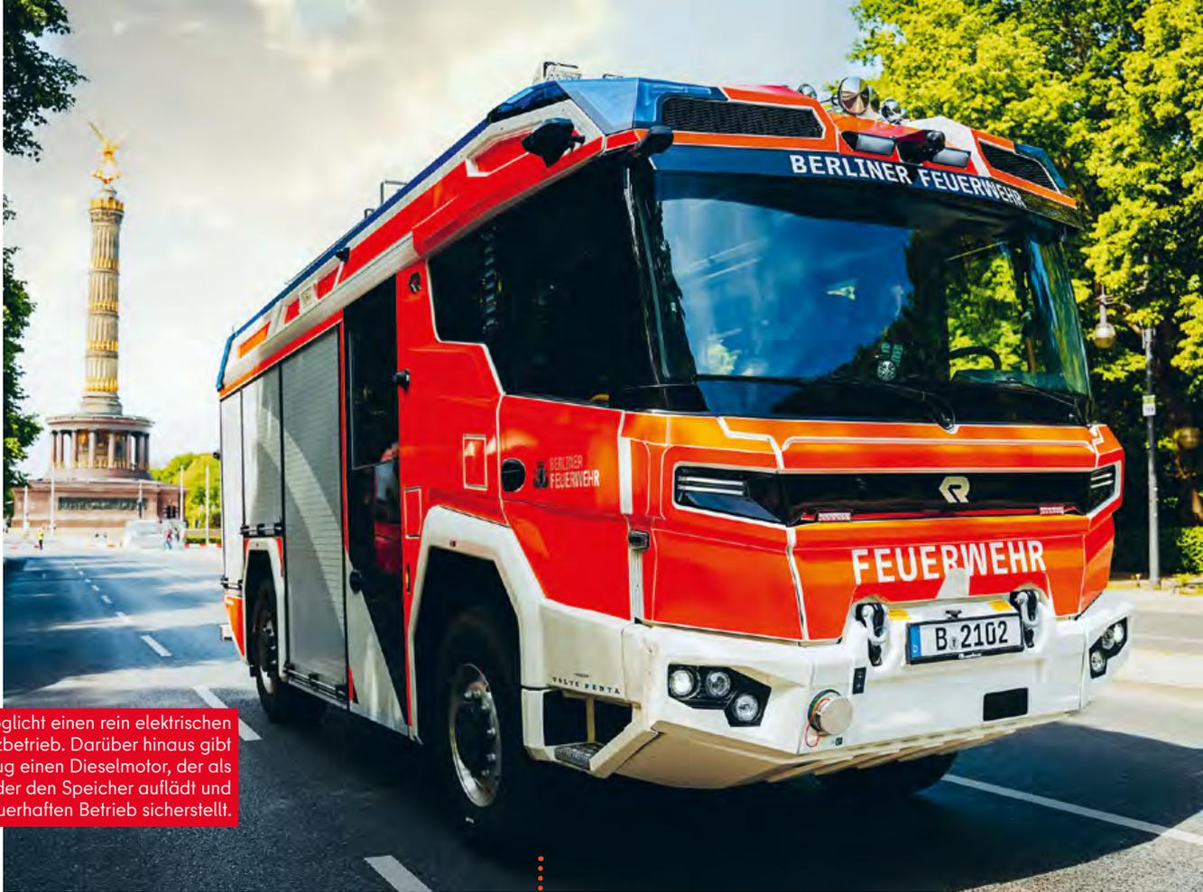
Das eLHF ermöglicht einen rein elektrischen Fahr- und Nutzbetrieb. Darüber hinaus gibt es im Fahrzeug einen Dieselmotor, der als Range Extender den Speicher auflädt und einen dauerhaften Betrieb sicherstellt.
