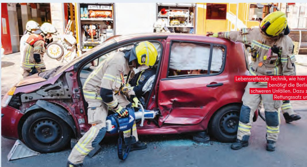
Lebensrettende Technik, wie hier bei einer Einsatzübung, benötigt die Berliner Feuerwehr auch bei schweren Unfällen. Dazu zählen der hydraulische Rettungssatz und Motor-Trennschleifer.
